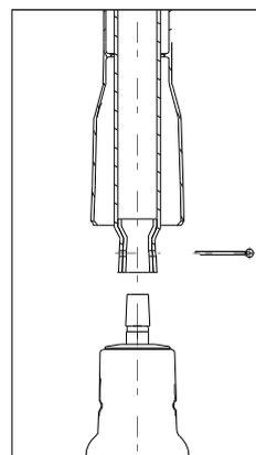
Задвинуть внутренний защитный кожух – удалить шплинт
