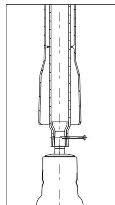
Установить вал штоков на четырехгранную головку шпинделя – вставить шплинт
